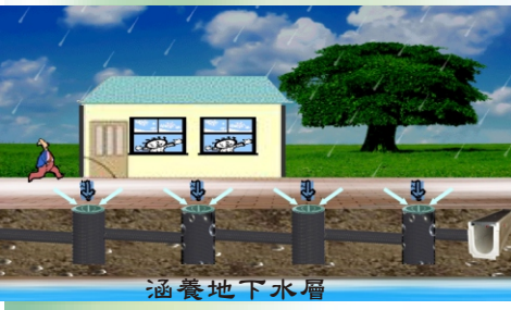
屋頂平台滲透排水
